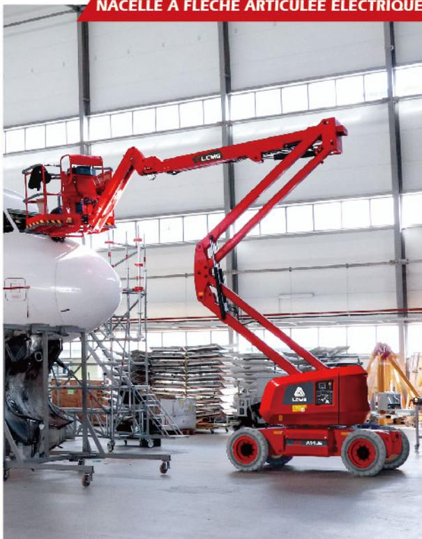
Les nacelles à flèche articulée électrique A14JE de LGMG apportent une solution respectueuse de l'environnement, à émissions nulles pour une utilisation à l'intérieur comme à l'extérieur. Avec une hauteur de plateforme allant jusqu'à 13,8 m et une flèche standard d'1,5 m, l'A14JE permet de contourner les obstacles dans des espaces restreints.
