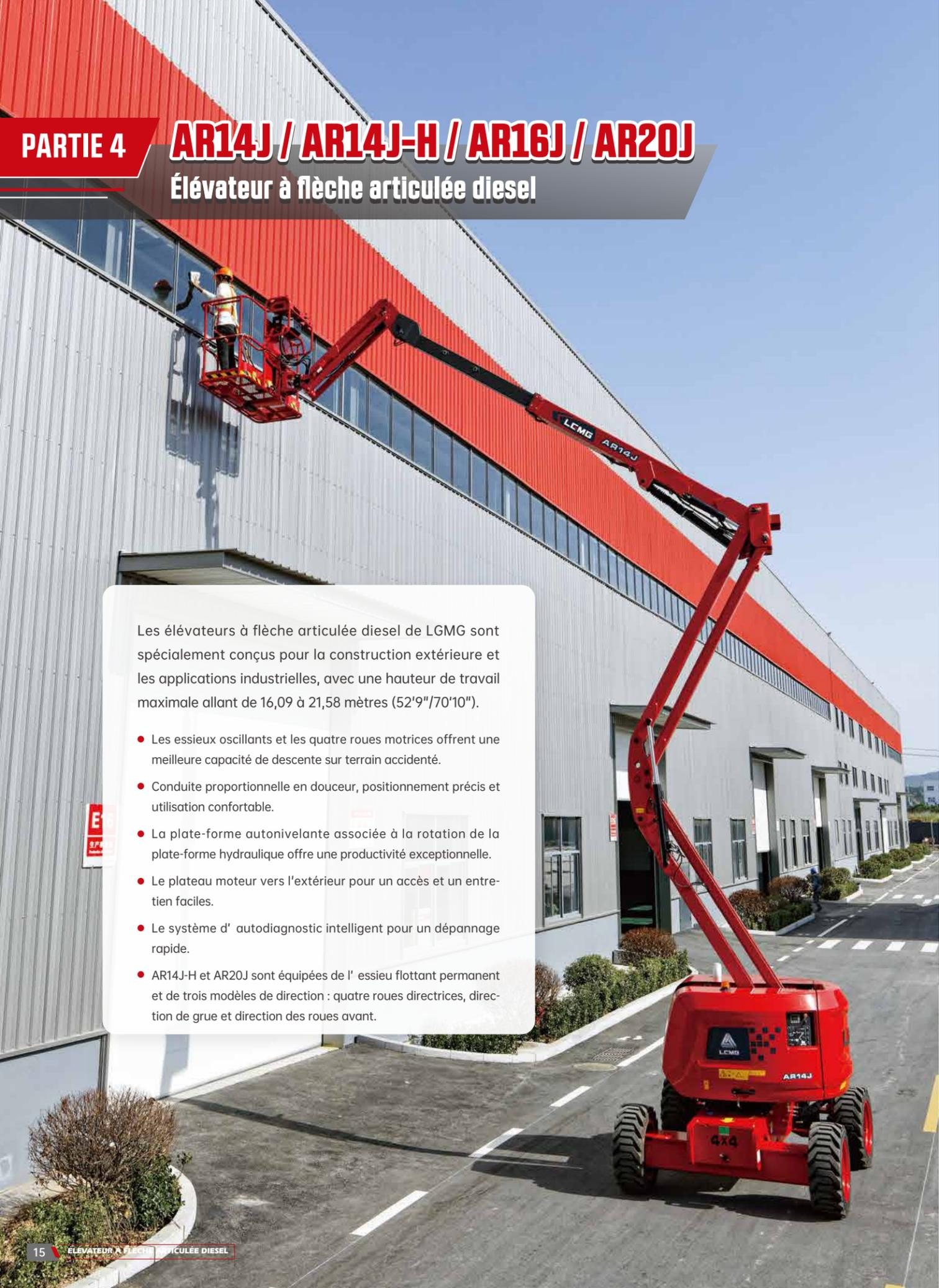
Les élévateurs à flèche articulée diesel de LGMG sont spécialement conçus pour la construction extérieure et les applications industrielles, avec une hauteur de travail maximale allant de 16,09 à 21,58 mètres (52'9"/70'10").
